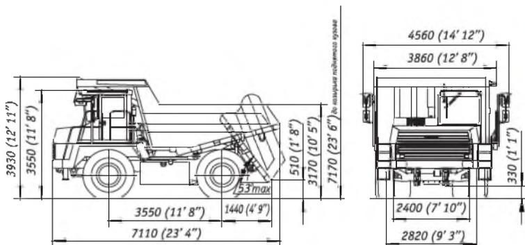
\*Габаритные размеры указаны для базовой комплектации самосвалов
